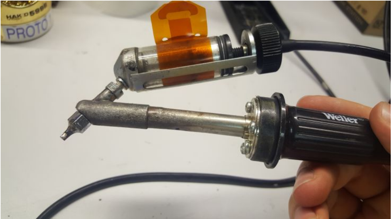
Illustration 2: "Pistolet" de dessoudage. Le bouton est caché au niveau du pouce
