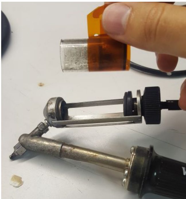
Illustration 5: Tube retiré. le vider en tapotant/grattant
