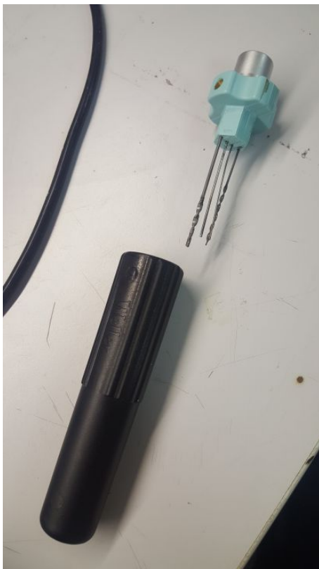
Illustration 8: Les tiges de ramonage s'obtiennent en tirant la partie bleu
