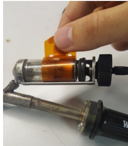
Illustration 4: La butée noire s'est décalée, on peut retirer le tube en tirant sur le plastique orange
