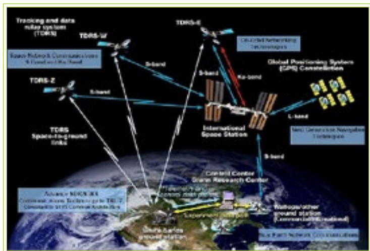
Fig. 5: Illustration de la complexité des communications spatiales pour transmettre les informations acquises autour de l'orbite terrestre, en particulier des satellites en orbite basse (ex-navette spatiale et maintenant ISS à 400 km, Hubble à 550 km) qui ne sauraient être exploités efficacement en n'étant visibles que quelques minutes par jour depuis une station au sol. Seule l'utilisation d'un réseau de communication de satellites en orbite géostationnaire (TDRS aux États-Unis, futur EDRS en Europe pour les satellites Sentinel) garantit une liaison quasi permanente entre une agence spatiale et ses satellites. Illustration prise sur le site earth.esa.int/web/eoportal/satellite-missions/i/iss-scan .
